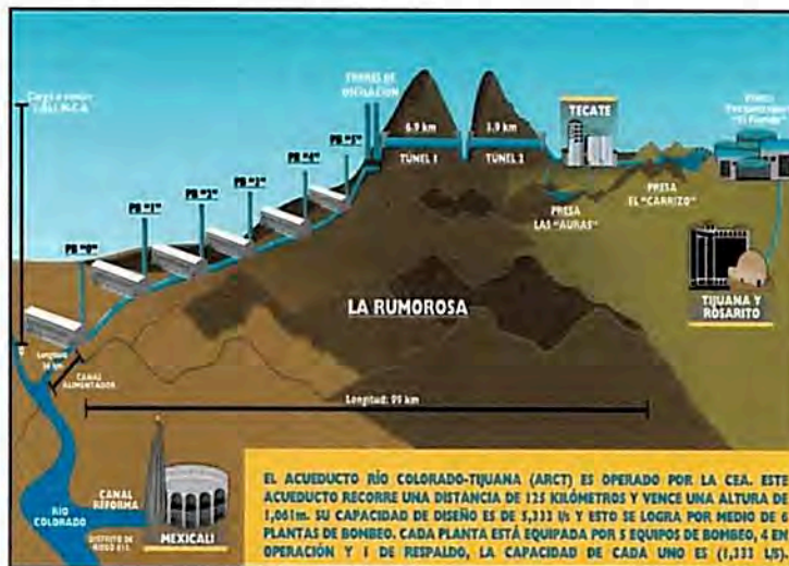
Figura 2. Descripción Acueducto Río Colorado - Tijuana
